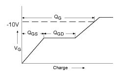
Fig 9a. Basic Gate Charge Waveform
